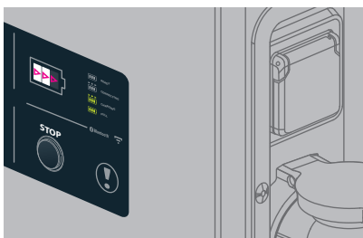
"Borne connectée au véhicule" en attente de charge (défilement blanc) (0 à 30" selon véhicules) Si ce temps est trop long, il est possible que le véhicule soit passé en mode "Veille", merci d'ouvrir et de refermer la porte du véhicule "Charging station connected to the vehicle" awaiting charging (white scrolling) (0 to 30 mins depending on vehicles) If the delay is too long, the vehicle may have gone into standby mode. Please open and then close the door of the vehicle.
